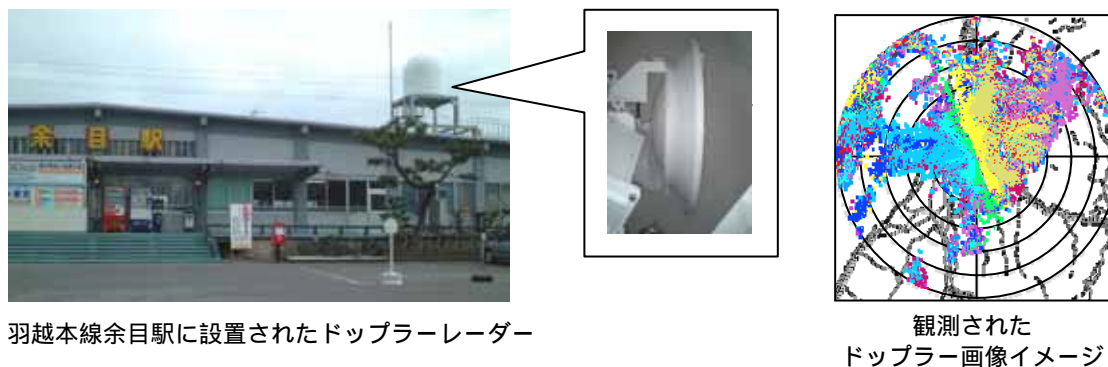
【図3】羽越本線余目駅に設置されたドップラーレーダーと画像イメージ
